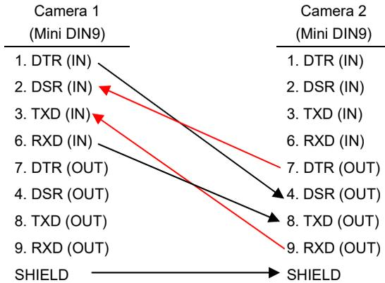
**Use the RS232 mini DIN9 to mini DIN8 cable**
